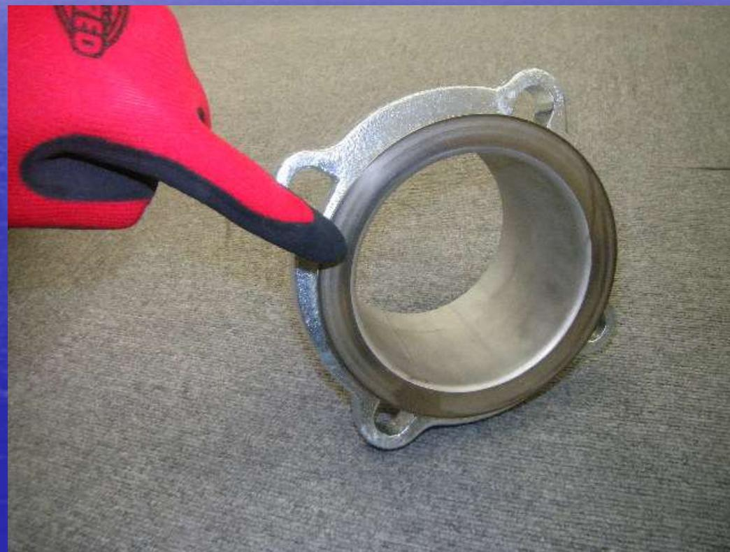
※ 管端部に凹み、傷等があると、漏水の原因となります
